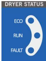
에어드라이어 상태 램프 - ECO : 에너지 절감운전 - RUN : 드라이어 운전 - FAULT : 드라이어 이상
